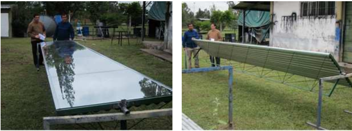
Figura 8: Vistas de la estructura de los concentradores
