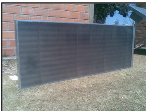
Figura 2: Colector solar ensayado en circuito abierto.
