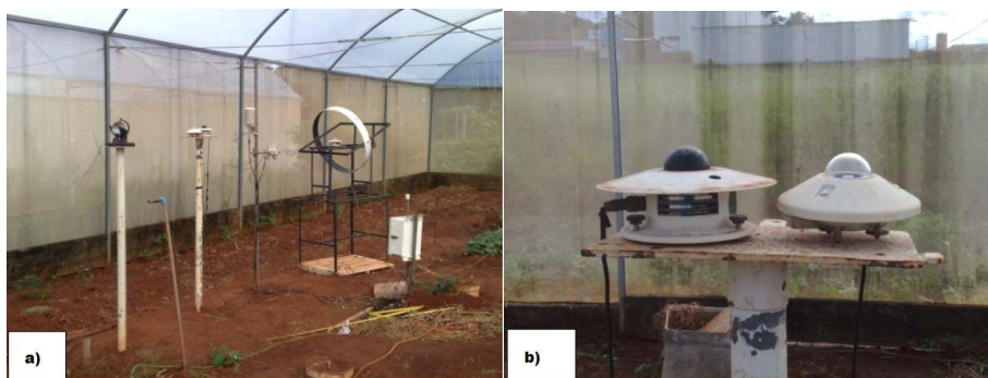
Figura 2: a) Disposição dos equipamentos no interior da estufa; b) Equipamentos para medição das radiações ultravioleta e infravermelha, em detalhe.
