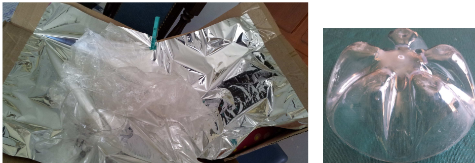
Figura 6: cocina solar de cartón a partir de una caja. Derecha: soporte de PET para olla.
