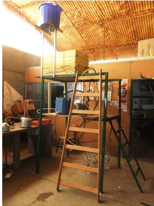
Fig 6: Destilador instalado en el laboratorio para realizar los ensayos
