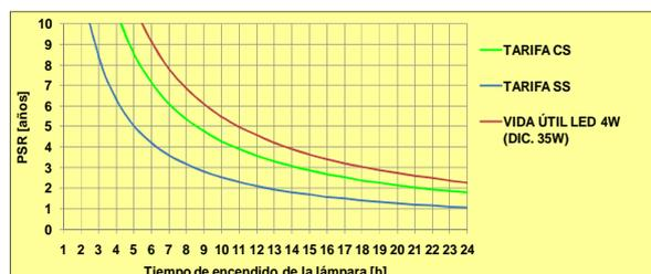
Figura 15. Vida útil y amortización, lámpara LED 4W
