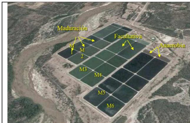
Figura 1. Imagen satelital del sistema de lagunas de estabilización de la Ciudad Capital de Catamarca. Módulos de Tratamiento.
