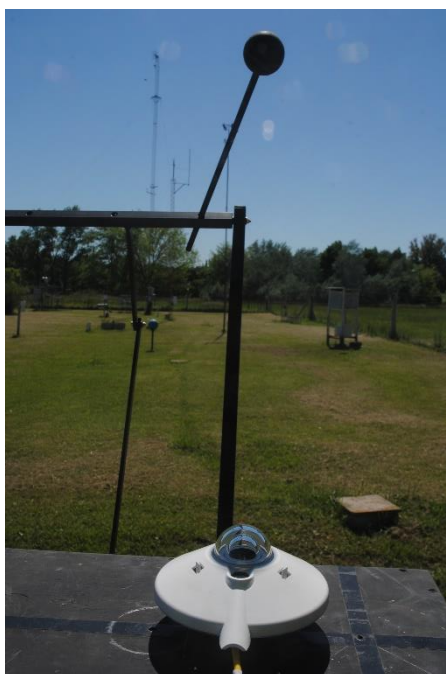
Figura 7: esfera sombreadora del Solys 2 tapando el solarímetro a calibrar en la posición "tapado".
