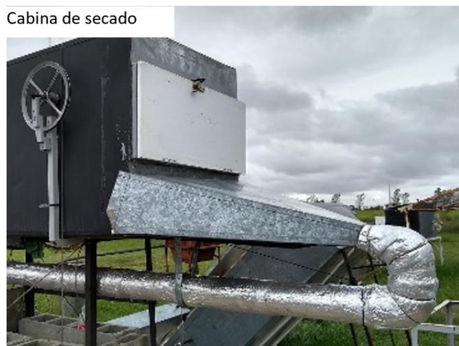
Figura 2 d. Vista trasera. Recolectación del aire de recirculación
