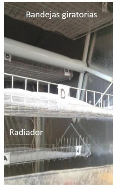
Figura 2 b. Interior de la cabina de secado
