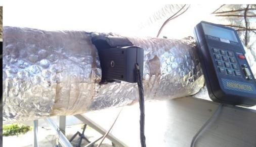
*Figura 5 a. Apertura en el ducto de recirculación para ingreso del anemómetro
