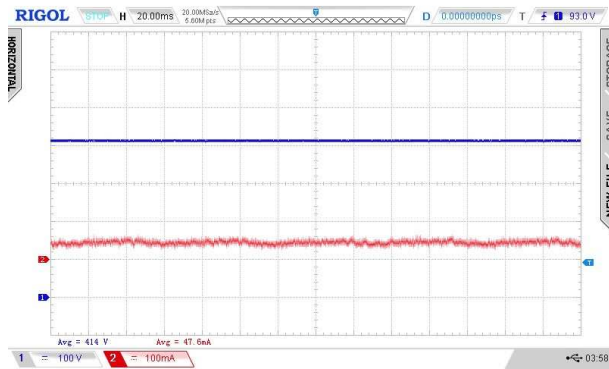
Figura 11: Tensión y corriente de salida del convertidor CC-CC conectado al inversor trifásico con carga lineal. (100V/div, 10A/div, 10ms/div).
