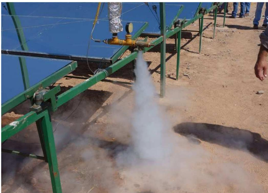
Figura 15.- Expansión del vapor producido en el generador solar térmico con una presión de  $30 \text{ Kg/cm}^2$ .
