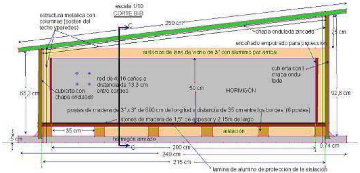
Figura 8. Corte transversal del acumulador mostrando los distintos materiales que lo forman.
