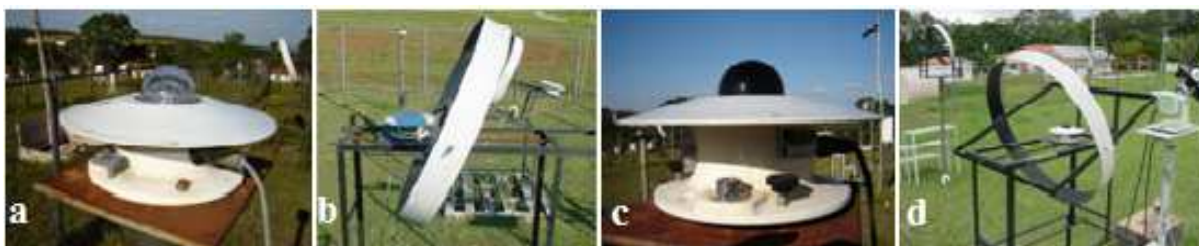
Figura(3) piranometro medindo A global total; b)piranometro com anel de sombreamento a difusa; c) pirametro a IV, e d) piranometro com anel de sombreamento a difusa infravermelho.
