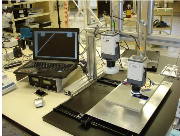
Figura 2. Equipo de inspección visual por el método de electroluminiscencia.
