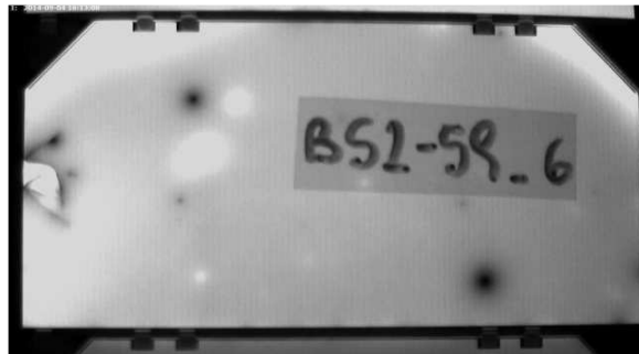
Figura 6. Celda con fisura en el borde lateral de la celda
