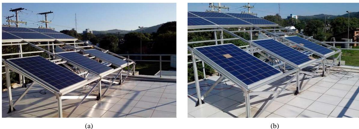
Figura 6: Instalação da série de módulos usada para testes (3 módulos da fileira inferior) (a) e os mesmos módulos artificialmente sombreados para provocar defeitos na curva característica (b).
