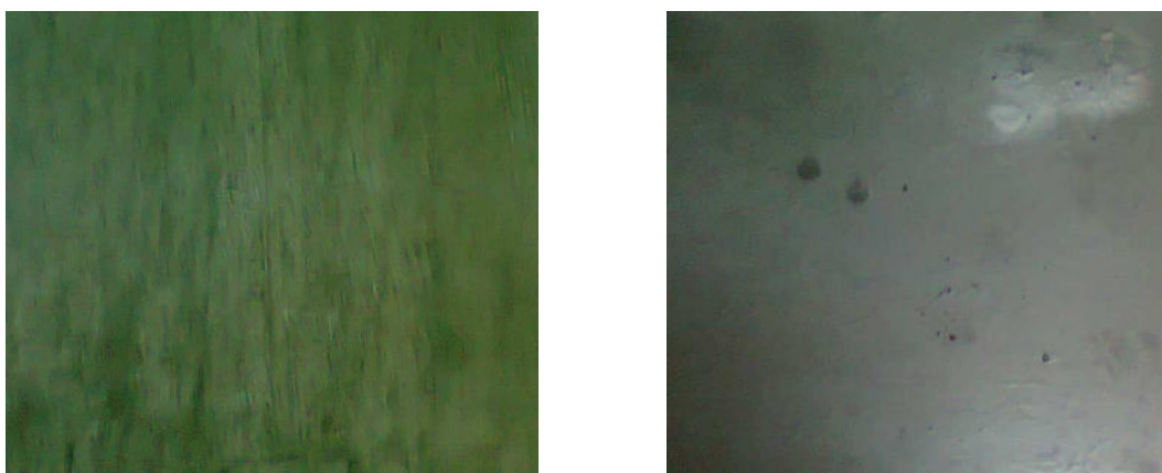
Figura 5: Fotografías de ambas superficies. Placa pintada con pintura absorbente a la izquierda. Placa con aerosol a la derecha.
