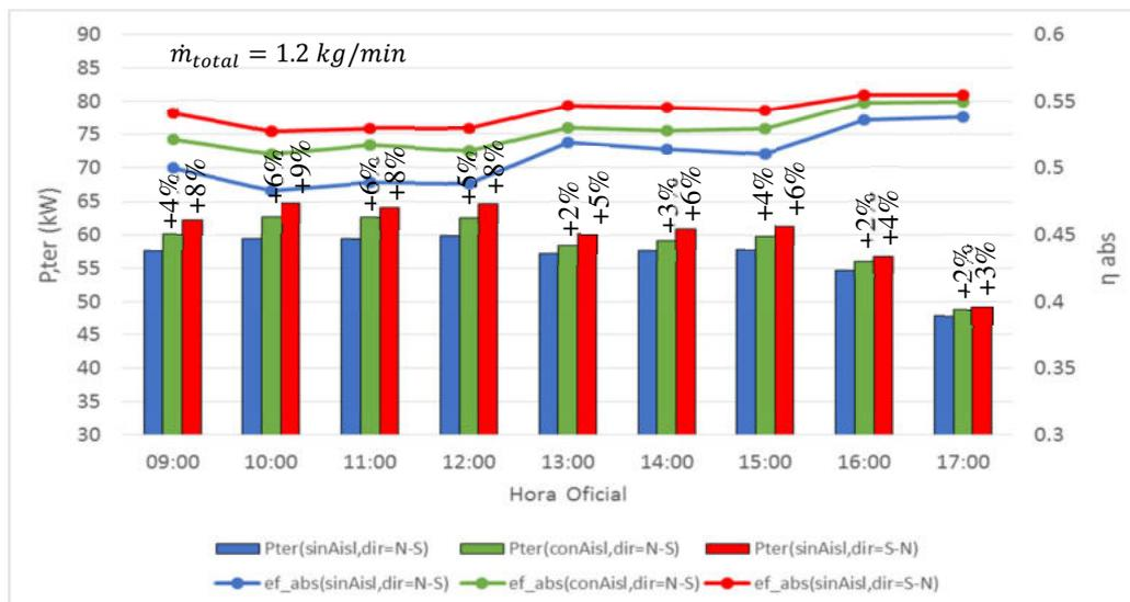
Figura 9:  $P_{ter}$  (kW) generada por el LFC y  $\eta_{abs}$ , para el 21 de Diciembre (tres casos de comparación,  $\dot{m}_{total} = 1.2 \text{ kg/min}$ ).
