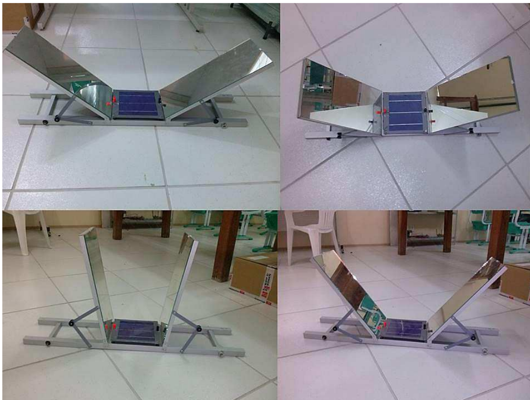
Figura 1: Concentrador solar tipo V desenvolvido.
