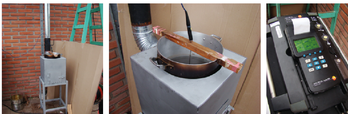
Figura 2. Ensayo de emisiones siguiendo el protocolo WBT. Vista general (izquierda), colocación del termómetro en el interior de la olla (medio) y equipo utilizado para el registro de datos (derecha).
