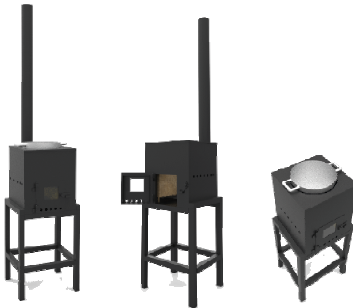
Figura 5: Vistas generales de la cocina diseñada, realizada en chapa de 1,2 mm y doble pared, utilizando el aire como aislante. La imagen de la derecha muestra la ubicación de la olla en el interior de la cámara de combustión.
