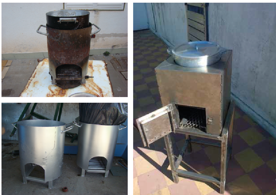
Figura 1: Brasero optimizado diseñado por Tom Lawand, Canadá (izquierda) y prototipo de la cocina diseñada (derecha)
