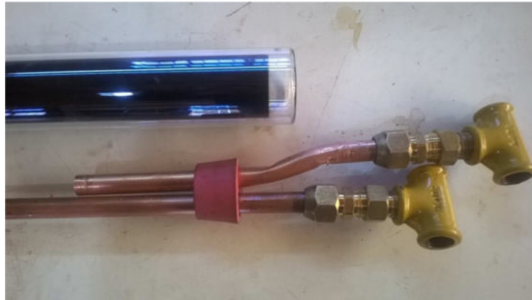
Figura 4: elementos que constituyen el absorbedor del equipo
