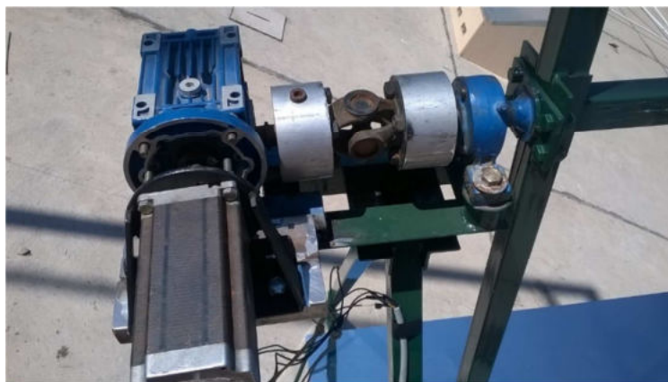
Figura 5: Sistema mecánico: motor, reductor y rodamientos
