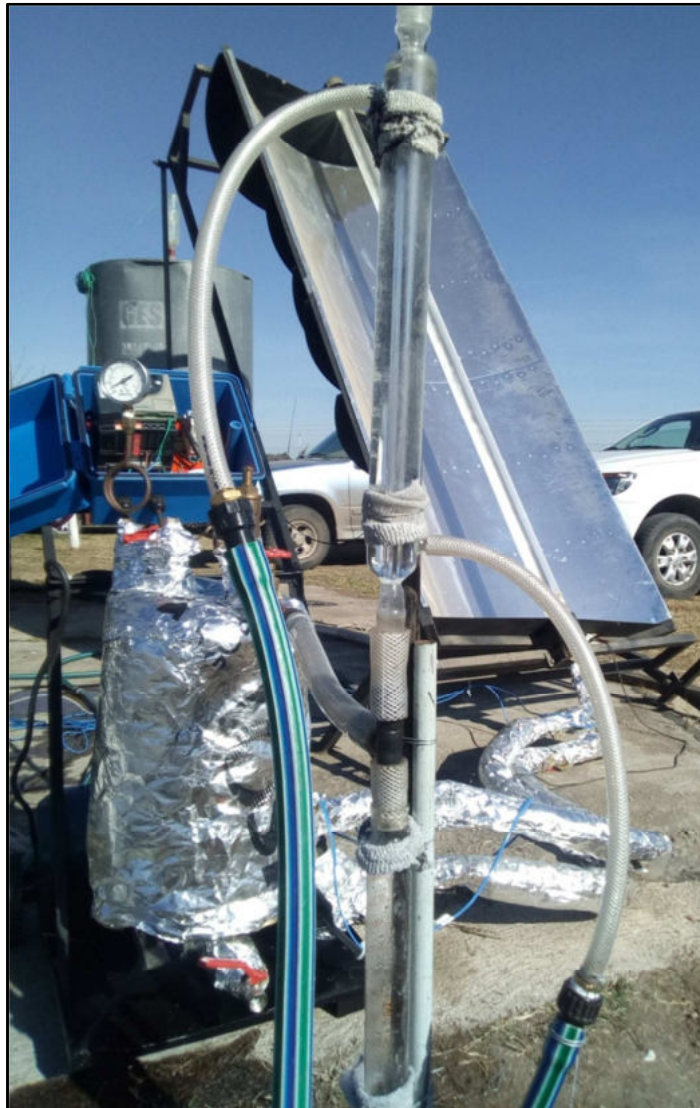
Figura 8. Vista del sistema de condensación para la determinación del caudal de vapor generado
