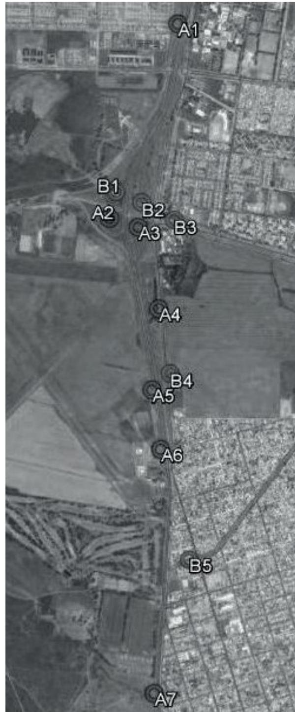
**Fig. 1:** Ubicación de los NR indicando el tipo de ambiente. A: canalizaciones a cielo abierto con sustrato de hormigón. B: bajos inundables, banquetas y canalizaciones con vegetación o suelo desnudo. Fuente: modificado de Google Earth
