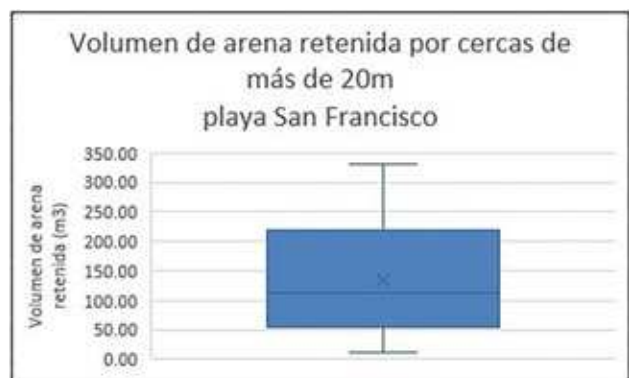
Figura 6. Arena retenida por cercas captoras de más de 20 m. de longitud.
